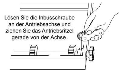
Abbildung 2-8 - Entfernen des Förderband-Antriebsritzels
